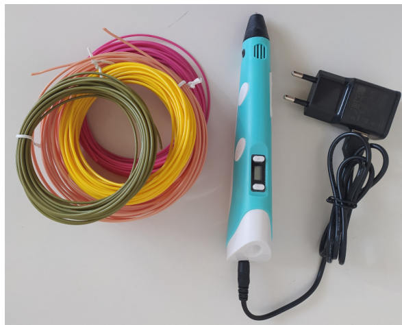
Obrázok 1: 3D pero spolu s farebnými filamentmi používanými na tvorbu modelov
