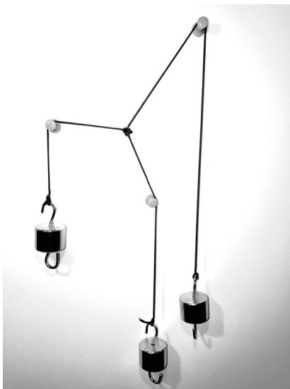
Obr. 3: Řešení pomocí závaží a kladek
