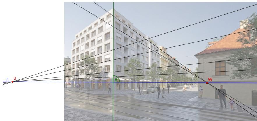
**Obrázek 2:** Určování úběžníků a horizontu (zdroj fotografie: PDS)
